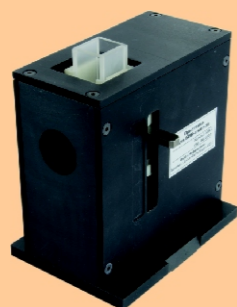
Приставка БИК в ИК фурье-спектрометре ФСМ
