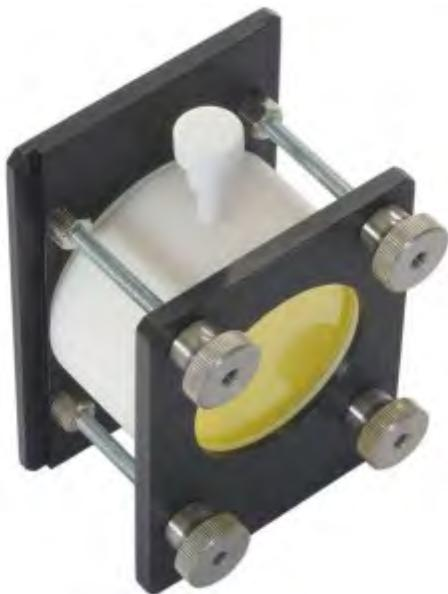
Кювета КР20 предназначена для исследования образцов жидкостей со слабым поглощением, а также суспензий в вазелиновом масле, приготовленных из твердых образцов.
