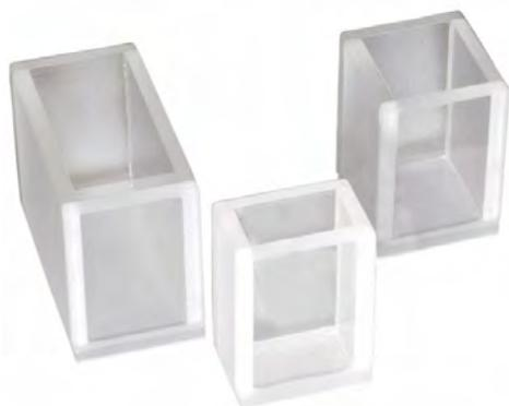
Кварцевые кюветы предназначены для исследования жидких образцов, имеют фиксированную длину оптического пути. Используются, в частности, для определения массовой концентрации нефтепродуктов в воде и масла в жидком аммиаке по ИК-спектру поглощения (область контроля — 2925 см<sup>-1</sup>).
