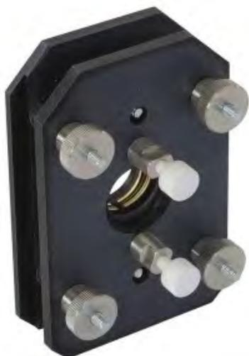
Кювета КР1 предназначена для исследования жидкостей, помещенных между двумя окнами в виде тонкого слоя, толщина которого определяется толщиной латунной прокладки, выбранной из стандартного комплекта. Образцы могут быть проанализированы в чистом виде или разбавляются соответствующим растворителем.
