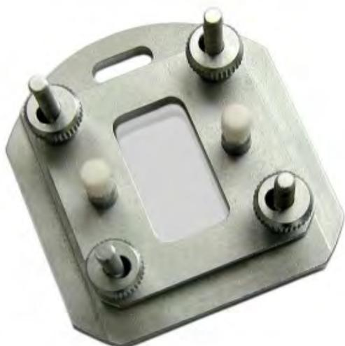
Кювета с герметично соединенными окнами имеет постоянную длину оптического пути и разборный корпус.
