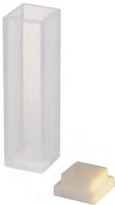
Кварцевые кюветы предназначены для исследования жидких образцов, имеют фиксированную длину оптического пути. Используются, в частности, для определения массовой концентрации нефтепродуктов в воде и масла в жидком аммиаке по ИК-спектру поглощения (область контроля — 2925 см<sup>-1</sup>).
