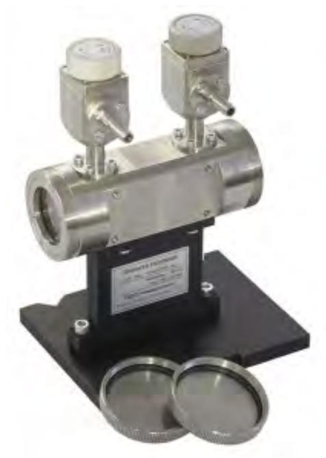
Кювета предназначена для определения примесей в газах с порогом  $< 1\%$ . Проточный режим или заполнение газом после вакуумирования. Корпус из нержавеющей стали, два сильфонных вентиля.
