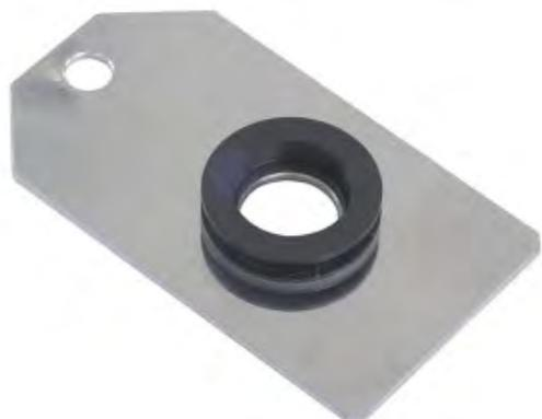
Держатель пленок ДП предназначен для фиксации образцов полимерных пленок. Приспособление состоит из стальной пластины, имеющей отверстие диаметром 16 мм, и магнита в форме кольца. Образец пленки помещается между пластиной и магнитом.
