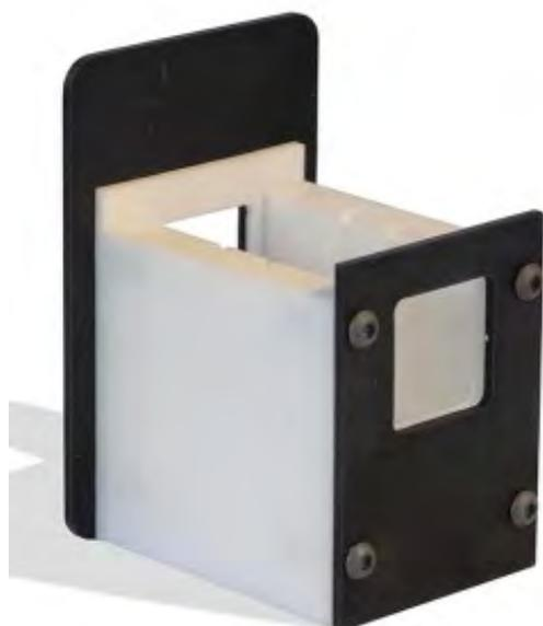
Для установки кварцевых кювет типа КФК в спектрометр ФСМ используется держатель ДК КФК, имеющий стандартную присоединительную планку размером 50x75 мм, с помощью которой он вставляется в подставку для кювет ПК50-75 инфракрасного фурье-спектрометра ФСМ.
