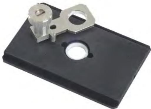
Держатель ДТ13 предназначен для фиксации с помощью механического прижима таблетки диаметром 13 мм, спрессованной из смеси перемолотого в порошок твердого образца и кристаллов KBr.
